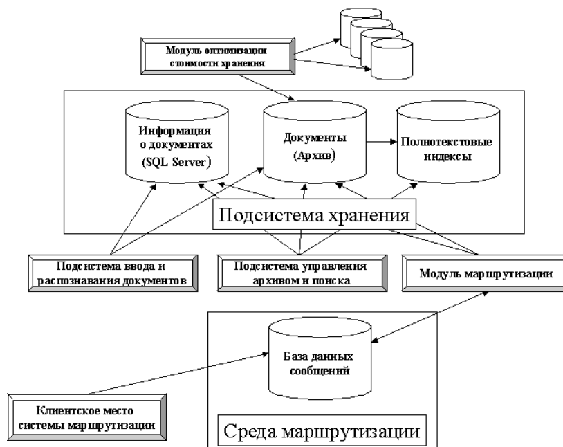
Структура идеализированной системы автоматизации документооборота
